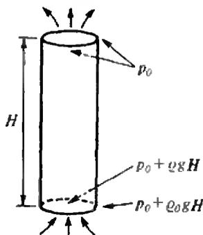
Очевидно, что нагрев приводит к уменьшению плотности воздуха, и архимедова сила, действующая на горячий воздух, поднимает его вверх, т.е. возникает восходящий поток воздуха в трубе.
