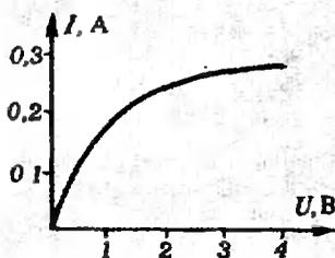
При последовательном подключении двух одинаковых лампочек напряжения на них будут одинаковыми и равными 2,5 В каждое (напряжение достаточно мощного источника не меняется при подключении к нему различных нагрузок). Таким образом, по цепи потечет ток (см. вольт-амперную характеристику)
